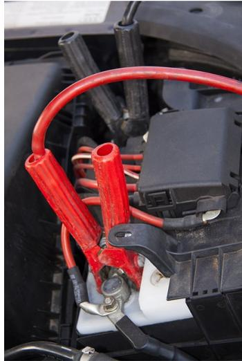
Wer eine Autobatterie mithilfe eines Starthilfekabels überbrücken möchte, muss zunächst die Kabel an der Batterie des Spenderfahrzeuges anbringen. Die rote Zange muss dabei am Pluspol, die schwarze am Minuspol angebracht werden. Anschließend muss der Motor des Fahrzeuges gestartet werden, bevor die beiden Batterien miteinander verbunden werden können. Am
