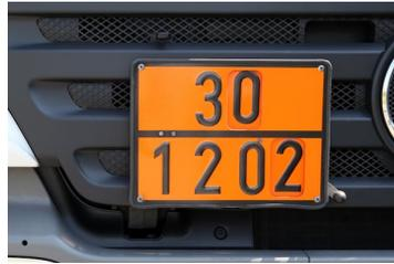
Durch **orange Warntafeln** werden Gefahrguttransporte kenntlich gemacht. Der Fahrer benötigt hierfür – zusätzlich zu einer Fahrerlaubnis der entsprechenden Klasse – eine ADR-Bescheinigung für das zu transportierende Gefahrgut.
