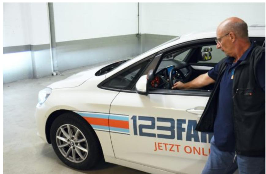
Ist das Lenkspiel größer, ist vermutlich das Lenkgetriebe defekt oder das Kugelgelenk der Spurstangen ausgeschlagen. In beiden Fällen kannst du den Pkw nicht mehr exakt in der Spur halten. **Das Auto muss daher sofort in eine Werkstatt.**
