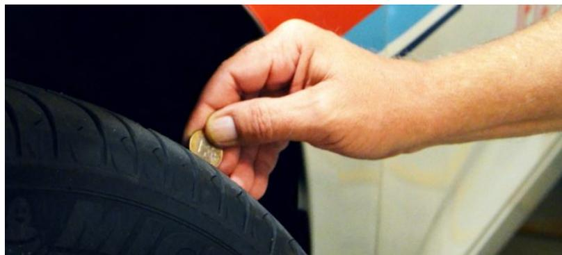
Du kannst zur Überprüfung aber auch einfach eine **1-Euro-Münze** verwenden. Da der goldene Rand genau 3 Millimeter breit ist, gilt: Wenn der Rand komplett im Reifenprofil versinkt, kann der Reifen weiterhin gefahrlos verwendet werden. **Ist ein Teil des Randes zu sehen, sollte über einen baldigen Reifenwechsel nachgedacht werden.**
