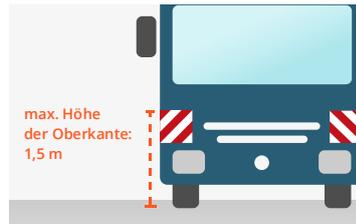
Durch **rot-weiße Warntafeln** kann auf die Überbreite eines Fahrzeugs hingewiesen werden.
