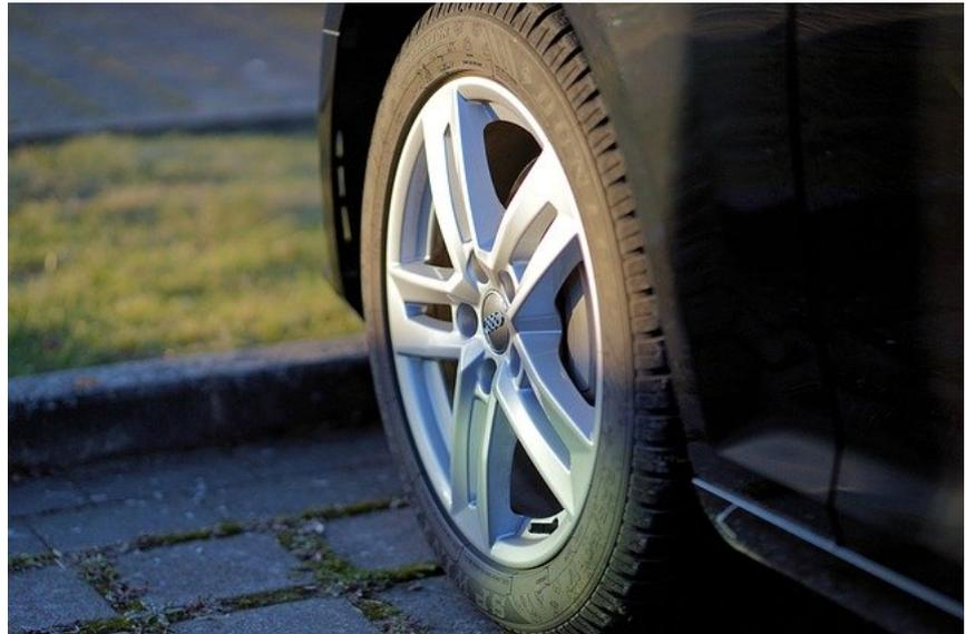
Wenn der Reifendruck zu niedrig ist, kommt es zu sogenannten Walkarbeiten. Das bedeutet, dass der Reifen sich beim Fahren deutlich verformt. Dadurch erhöht sich der Rollwiderstand und der Kraftstoffverbrauch steigt an. Achte daher immer auf den richtigen Reifendruck. Dadurch lässt sich Kraftstoff sparen und die Umwelt schonen.
