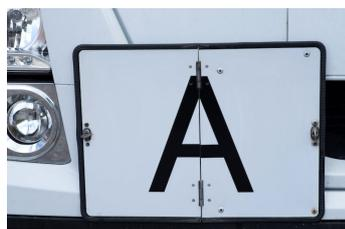
Wenn an einem Lkw eine **weiße Tafel mit einem schwarzen A** angebracht ist, bedeutet dies, dass in diesem Fahrzeug Abfall transportiert wird.
